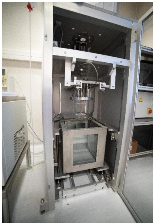
Unutrašnjost hidrostatičkog instrumenta za gustinu
