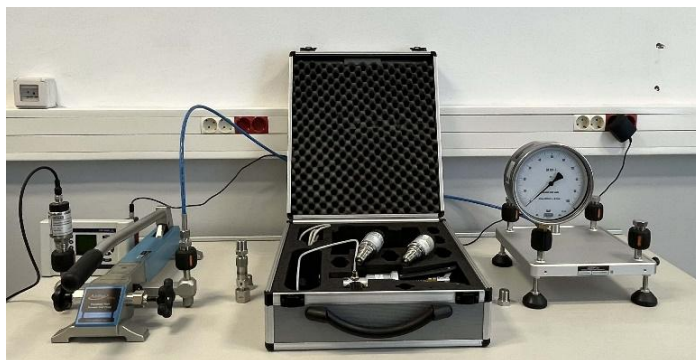
Additel 919A pneumatska visokotlačna testna pumpa sa Wika CPH6000 procesnim kalibratorom i referentnim senzorima pritiska
