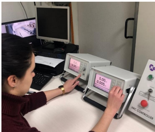
Podešavanje mjernih postavki na elektrometrima
