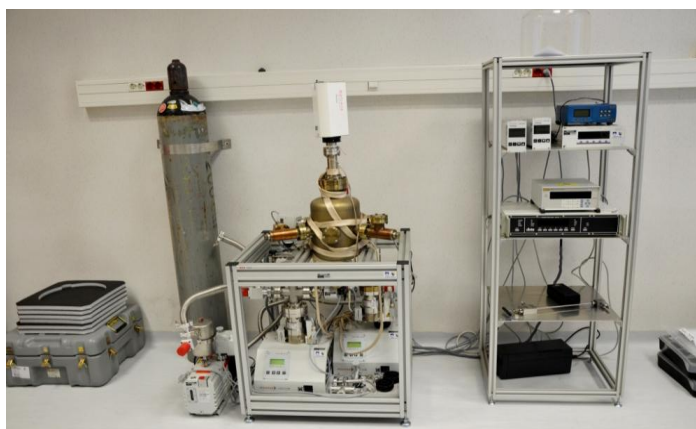
Vakuum sistem sa pripadajućim etalonima: SRG, CDG1, CDG2 i CDG3
