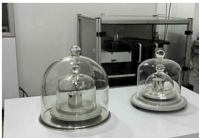
Etaloni 1 kg E0 klase tačnosti i komparator CC 10000 U-L od 1 kg do 10 kg, rezolucije d=0,01 mg
