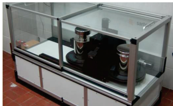
Slika gore: Komparator CC50001S-L
