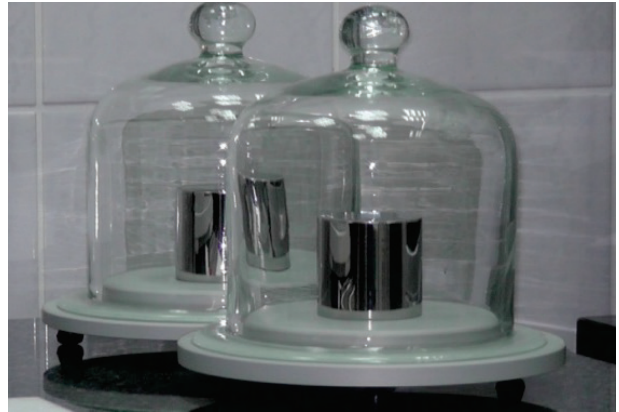
Slika gore: Etalon 1 kg „E0“ teg
