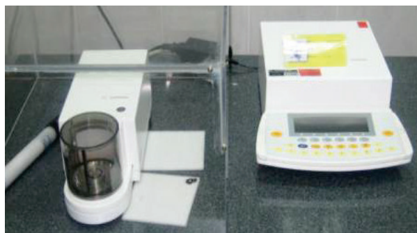
Slika gore: suszeptometar za mjerenje magnetizma tegova
