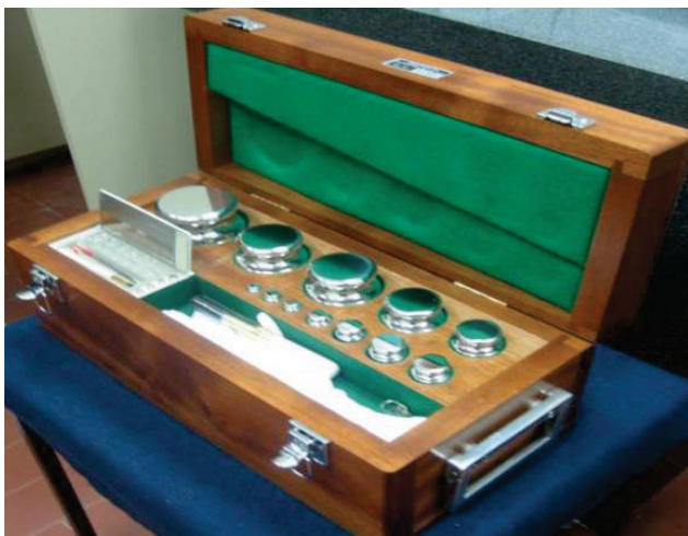
Slika gore: Etalonska garnitura E1 klase tačnosti od 1mg do 5 kg
